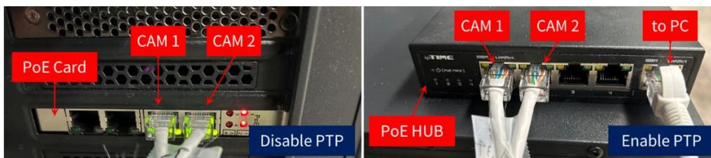
PTP를 활성화해야 할 경우 *Camera Control* 창의 *Enable PTP* 버튼을 클릭하십시오. PTP를 활성화하게 되면 디바이스는 약 몇 초간 두 카메라의 동기화를 진행합니다. 이 때 카메라의 *PTP Stat*은 *Listening*으로 표기됩니다. 이후 동기화가 완료되면, 하나의 카메라는 *Master*상태, 다른 하나의 카메라는 일시적으로 *Uncalibrated*였다가 이후 *Slave* 상태가 됩니다. 만일 아무리 기다려도 *Uncalibrated*에서 *Slave*로 상태가 전환되지 않는다면, *Reconnect All Cameras* 버튼을 클릭하여 카메라를 재연결하십시오.
